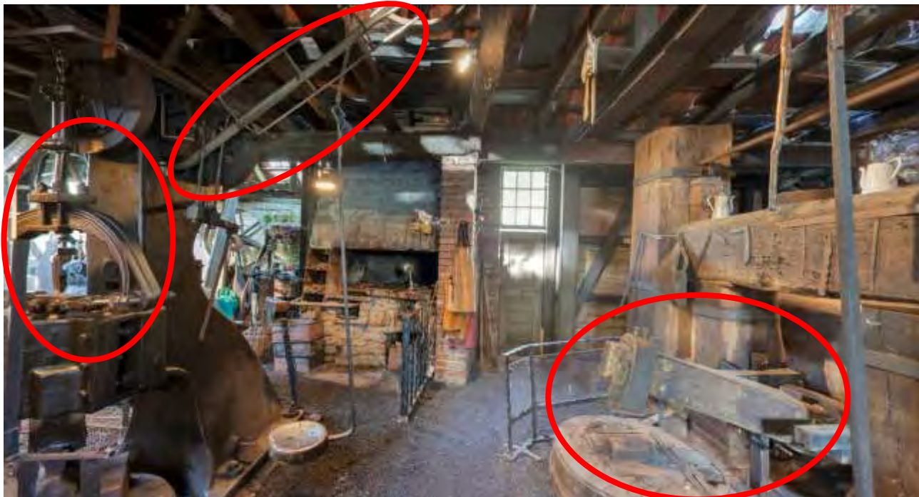
Steffenshammer innen; rechts Schwanzhammer; links Blattfederhammer; unter der Decke Transmission mit Riemenantrieb
